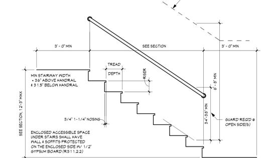
**5 2015 IRC STAIR/HANDRAIL DETAIL** 1/2" x 1'-0"
